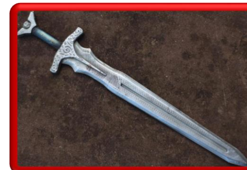
Obr. 7 Spojenie FDM tlače a pokovovanie – meč z hry Skyrim
