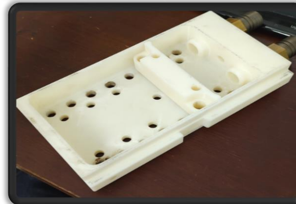
Obr. 8 Vytlačené časti vstrekovacieho nástroja
