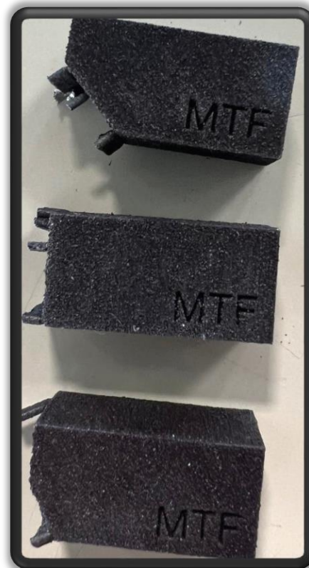
Obr. 8 Vzorky na meranie drsnosti tlačené SLM z maraging ocele
