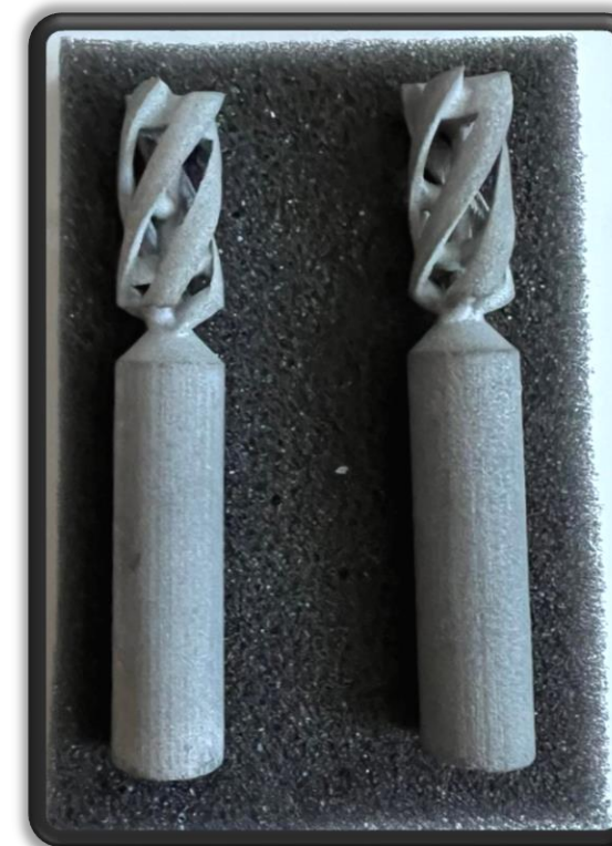
Obr. 11 Rezný nástroj navrhnutý pomocou generatívneho dizajnu
