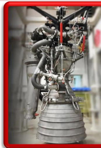
Obr. 3 Raketový motor s tlačenými dielmi
