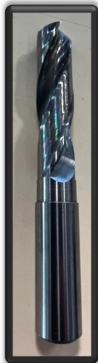
Obr. 9 Odliaty nástroj z tlačenej formy technológiou SLA
